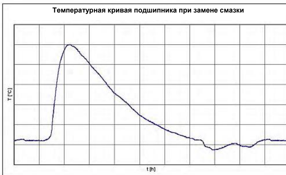
РИСУНОК 22. ТЕМПЕРАТУРНАЯ КРИВАЯ ВО ВРЕМЯ ЗАМЕНЫ СМАЗКИ
